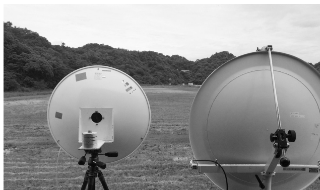
受信用パラボラアンテナ越しに見る不要発射測定場
