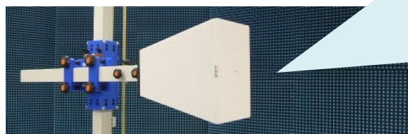
小型TEMホーン (プロトタイプ), アンテナ長 30 cm
