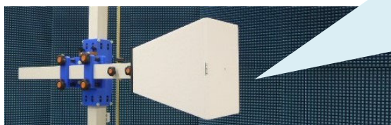
小型TEMホーン (プロトタイプ), アンテナ長 30 cm
